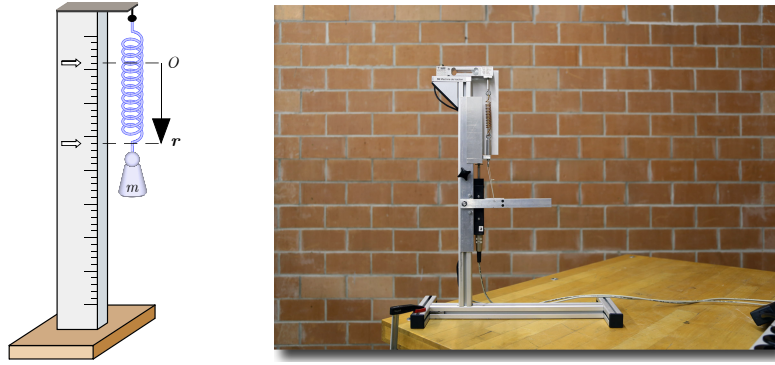
FIGURE 4.2 Vérification de la loi de Hooke dans le domaine de déformation élastique linéaire. La force élastique \mathbf{F}_e et la déformation élastique \mathbf{r} d'un ressort, à l'extrémité duquel est suspendu un point matériel de masse m , sont mesurées avec des capteurs.
