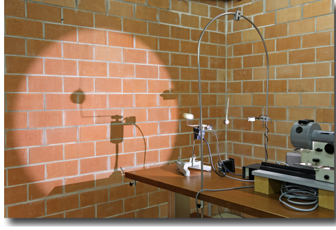
FIGURE 4.11 On observe sur un mur l'ombre projetée d'un pendule et d'une bille en mouvement circulaire uniforme. On peut ajuster la vitesse angulaire et superposer les deux projections.
